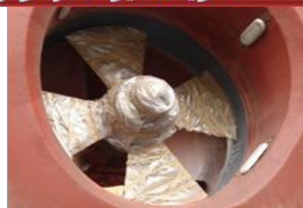
کاویتاسیون در تونل تراستر سینه کشتی اصلاح با بلزونا 1311
