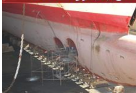
کاویتاسیون در تونل تراستر سینه کشتی اصلاح با بلزونا 1311
